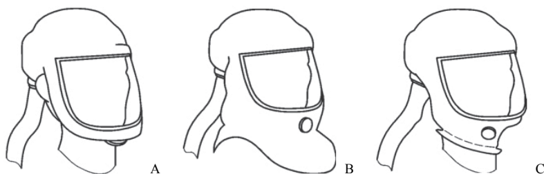
图 1 常见正压防护头罩结构形式分类(A: 开放型面罩; B: 开放型头罩; C: 密封型头罩)
